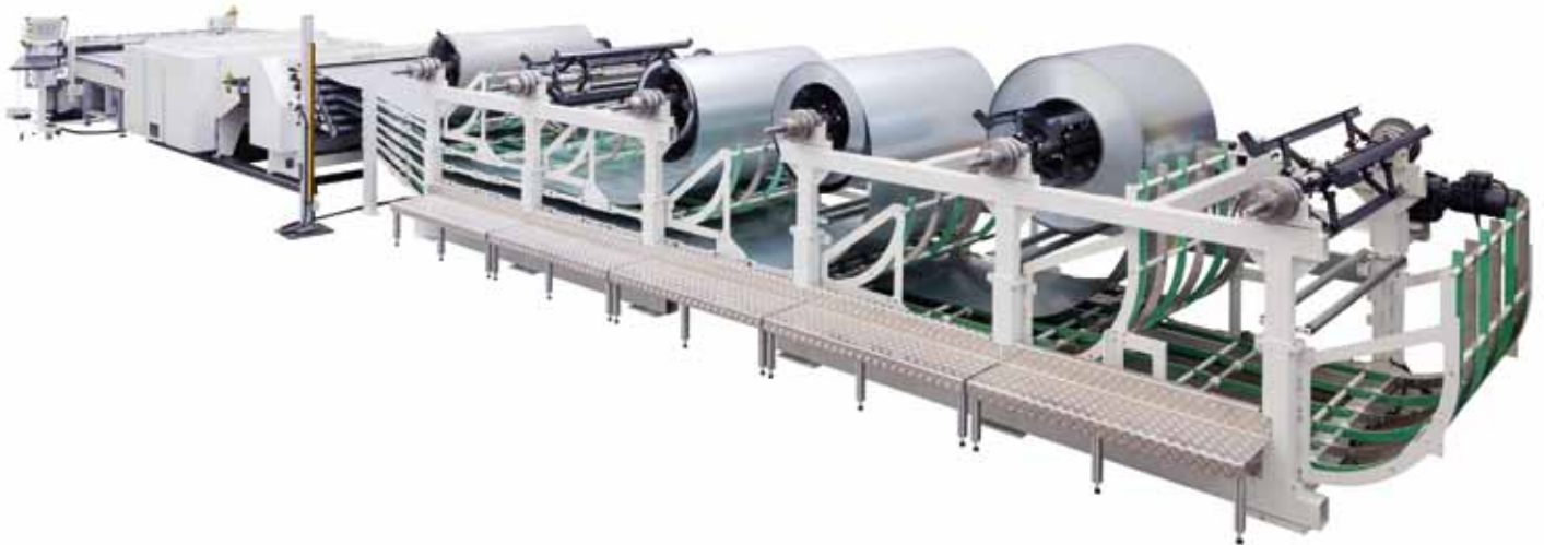
Abwickelgeräte mit Blechbahnen zum unterschlägigen Abwickeln, geeignet zur Kranbeladung
