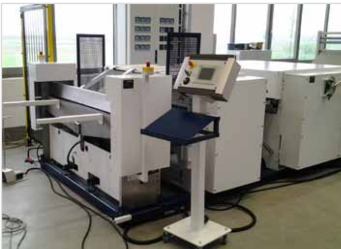
KS-4 1500 Kanalstrasse mit 4 Abwickelgeräten
