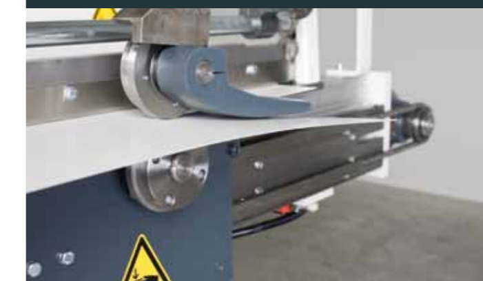
Riktig lengde kuttes ved hjelp av manuell eller elektrisk rullesaks eller giljotin saks. Systemene kan også bygges ut med ekstra funksjoner som for eksempel recoiling av plate
