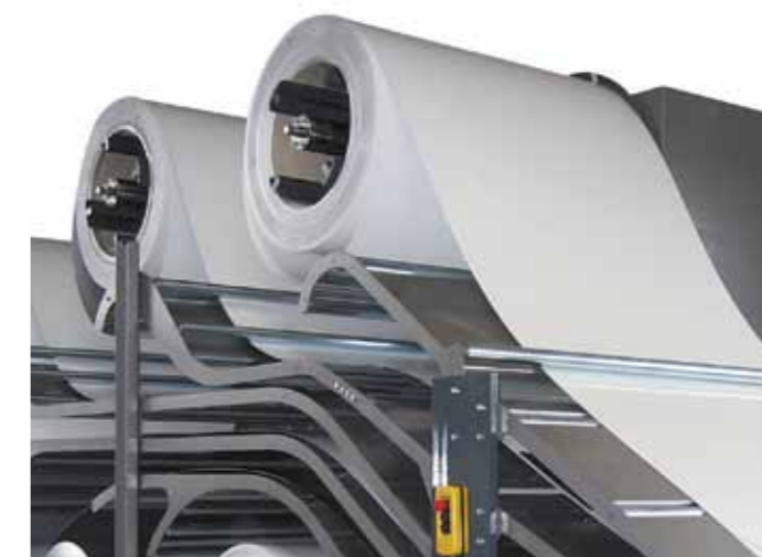
Ένα έως οκτώ ζετυλιχτικά (με ή χωρίς κινητήρα) από 300 έως 12000kg (26000lbs)
