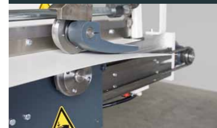
Κοπή στο επιθυμητό μήκος με χειροκίνητο/ηλεκτρικό σχιστικό ή ψαλίδι και επιπλέον λειτουργίες όπως π.χ. τύλιγμα
