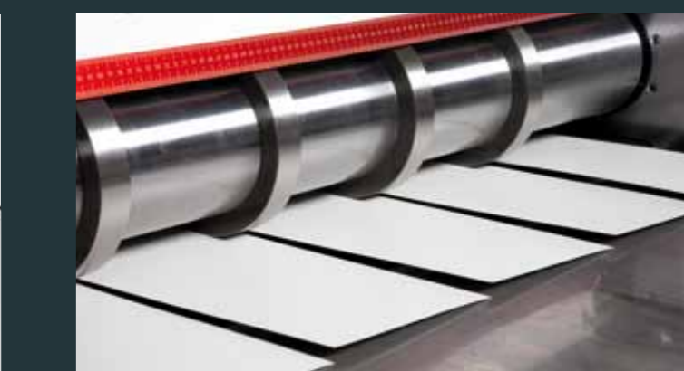
Σχίσιμο με ένα έως δέκα ζευγάρια λεπίδων με χειροκίνητη ή αυτόματη ρύθμιση πλάτους
